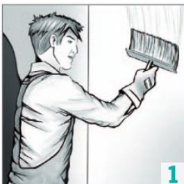
Unebenheiten, Risse und grobe Beschädigungen mit setta mur Glättputz oder setta Fertigspachtel planeben spachteln.
