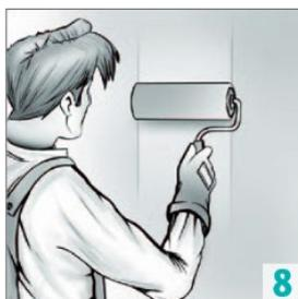
Bei Sondertapeten (Vinyl, Textil, Metall): Dampf-Dichte Tapeten sind zur Überarbeitung der Innendämmplatte PU aufgrund der beidseitigen Dampfsperre nicht geeignet. Bitte kontaktieren Sie im Zweifelsfall den Tapetenlieferanten.
