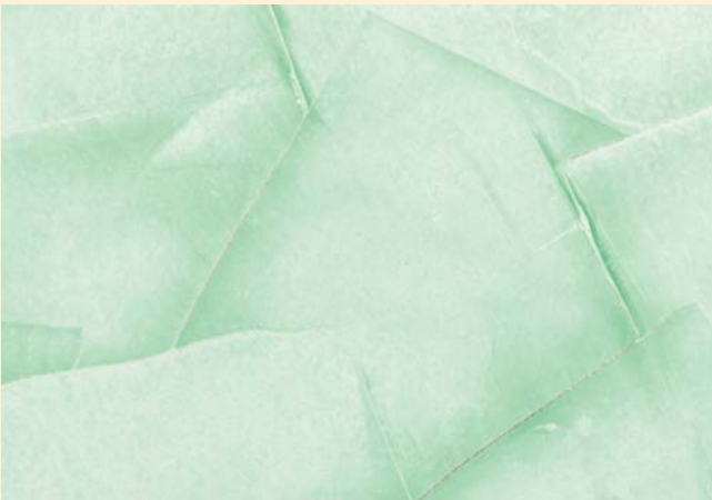
Untergrund: setta creativo MINERALISCHE SPACHELTECHNIK Venedig Farbton weiß. Glanzüberzug mit dem transparenten setta creativo WACHS-FINISH Neapel grün (mit Abtönkonzentrat) abgetönt.
