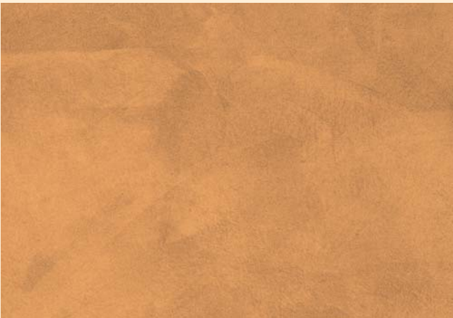
setta creativo Gold-DECO-SPACHTEL Meran auf Fläche setta Innenspachtel Leicht, Materialauftrag leicht verdünnt
