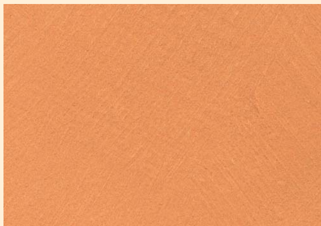
Untergrund: setta Silikat Streichputz Farbton hell terracotta. Erster Lasurauftrag setta creativo SILICAT-LASUR Palermo im Farbton: NCS S1050-Y30R
