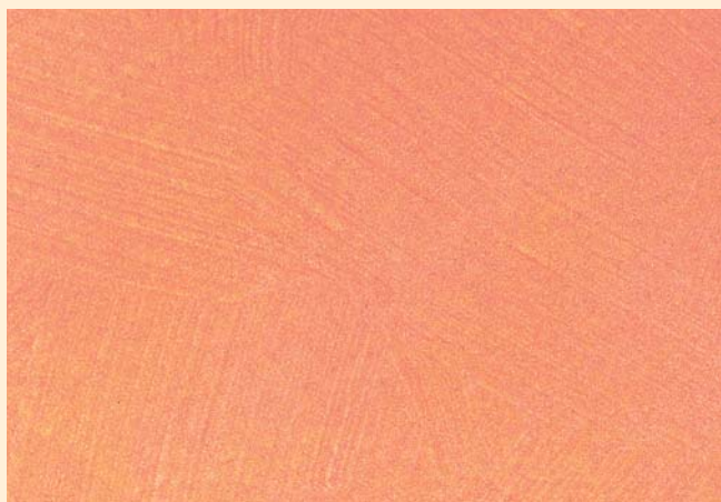
Untergrund: setta Silikat Streichputz weiß. Erster Lasurauftrag: setta creativo SILICAT-LASUR Palermo im Farbton: NCS S 0520 Y10. Zweiter Lasurauftrag: setta creativo SILICAT-LASUR Palermo im Farbton: NCS S 1040-Y70R
